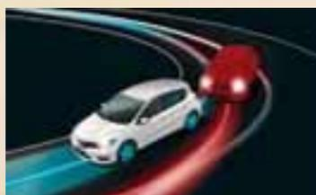
**CONTROLLO ATTIVO DELLA TRAIETTORIA.** Il dispositivo di controllo attivo della traiettoria ti permette di tenere sotto controllo la vettura in curva, frenando le singole ruote e gestendo la situazione con dolcezza e precisione.
